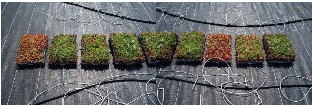
Abbildung 11 Gesamteindruck der Substratvarianten 1 bis 8 der 1. Wiederholung am 28.06.2024 von links nach rechts: 1a: ohne PROPLANTIS, ohne Düngung 7a: 7,3 Vol.-% PROPLANTIS, mit Düngung 6a: 3,6 Vol.-% PROPLANTIS, mit Düngung 4a: 10,9 Vol.-% PROPLANTIS, ohne Düngung
