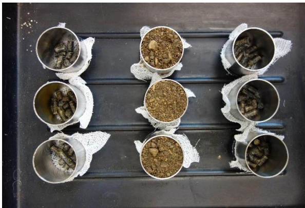
Abbildung 1 Proben (Frischmasse) zur Bestimmung der max. Wasserkapazität (links: 10 g PROPLANTIS in 100 mL Zylinder, Mitte: 100 mL Extensivsubstrat verdichtet, rechts: 15 g PROPLANTIS in 100 mL Zylinder) vor dem Bewässern
